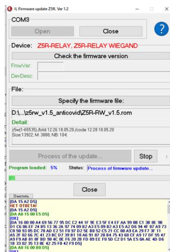
В течение 15-ти секунд подать питание на считыватель, пока программа пытается соединиться со считывателем. Если питание на считыватель было подано, то нужно снять и снова подать питание. Для контроллера Z-5 (мод. Relay Wiegand) перед подачей напряжения необходимо замкнуть клеммы «GND» и «EXIT».
